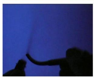
In questo filmato viene visualizzata la notevole emissione di vapori di mercurio che seguono l'apertura di una capsula di amalgama predosata appena attivata tramite vibrazione.
